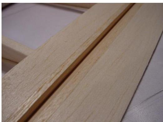
Biseauter le bord d'attaque de l'aileron pour permettre le débattement vers le bas, la charnière se situant à l'extrados, réalisée avec le film d'entoilage.
