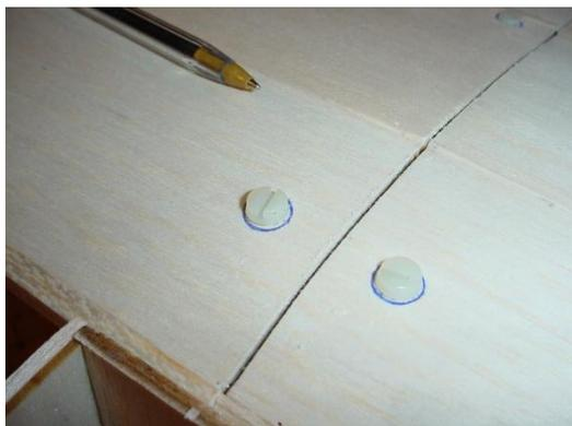
Fixer les ailes sur le fuselage, tracer le contour des têtes de vis pour ensuite retirer le surplus de balsa afin que les têtes de vis se noient dans l'aile.
