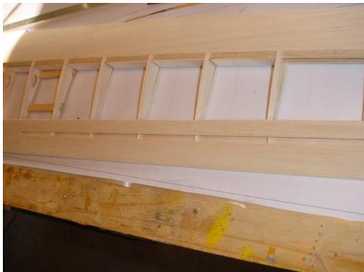
Tracer l'axe d'articulation de l'aileron. Tracer un trait à 3 mm devant l'axe et un autre trait à 3 mm derrière l'axe. Découper et retirer la bande de coffrage.
