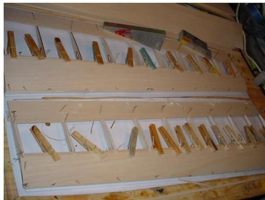
Coller le coffrage entre le bord d'attaque et la mi-largeur du longeron principal.
