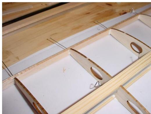
Coller le faux bord d'attaque (balsa 3 mm)
