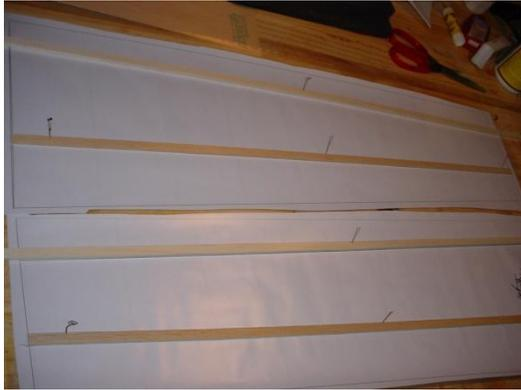
Epingler le longeron principal sur le plan, fixer une deuxième baguette en retrait pour caler les queues de nervures (voir position sur le plan)
