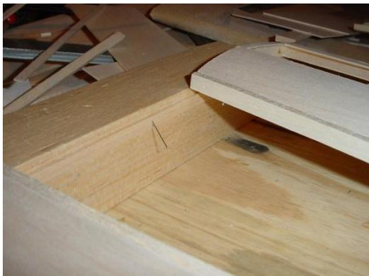
Ici, la cale est constituée d'une baguette épinglée sur un bloc de balsa de 50x50 mm.
