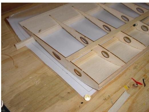
Caler l'aile à l'envers sur le chantier, la cale doit toujours être parallèle au longeron.
