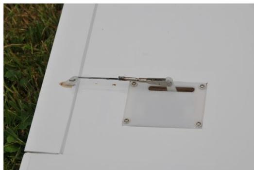
Servo d'aileron fixé sur des trappes en pvc (accessoire du commerce). Commande ultra courte en corde à piano.
