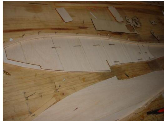
Coller le flanc interne (fibre à contre sens, dans du balsa de 2 mm)
