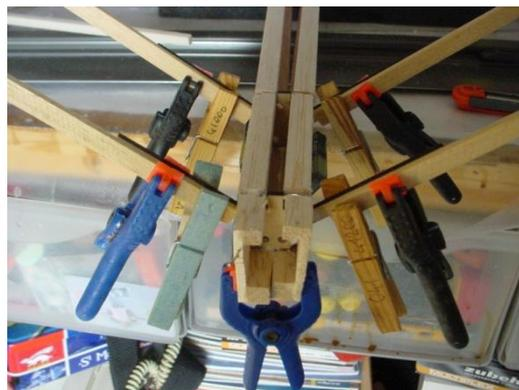
Glisser puis coller entre les flancs les pièces F8 et F9. Noter les baguettes provisoirement fixées à l'aide d'épingles. Elles donnent un repère pour le contrôle de la géométrie vis à vis de l'aile.
