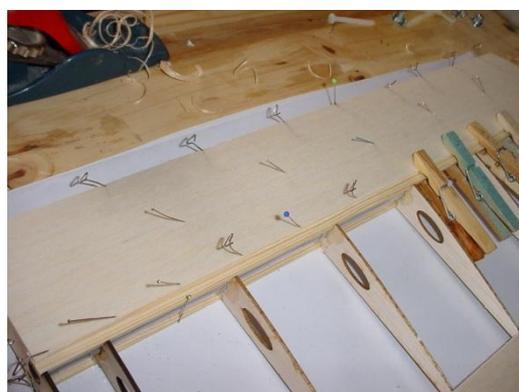
Coller le coffrage entre le longeron et le bord d'attaque (à mi largeur sur le longeron)
