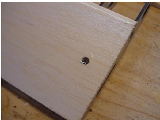
Utiliser le perçage dans A1 comme guide pour dégager un trou dans le coffrage
