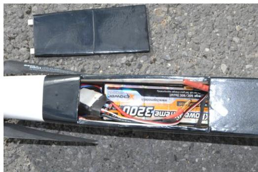
Logement du contrôleur et de l'accu (plus ou moins avancé suivant le centrage désiré)
