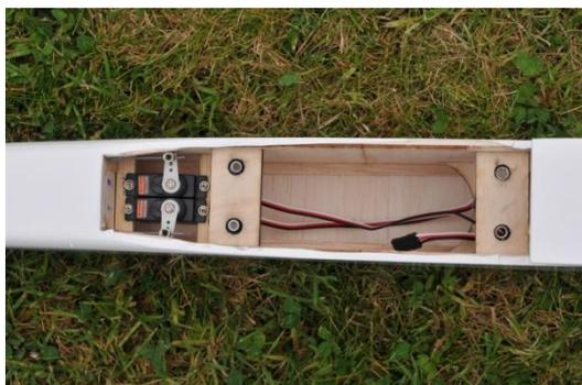
Installation des mini servos pour l'empennage papillon.
