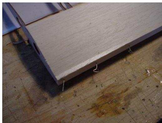
Coller le vrai bord d'attaque (balsa 5 mm).
