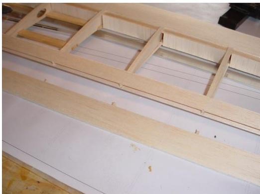
Séparer l'aileron de l'aile en coupant les nervures, retirer l'excès de nervure
