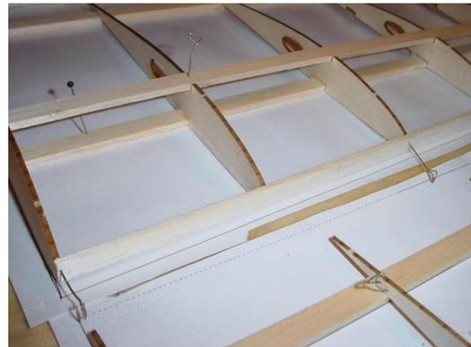
Coller le faux bord d'attaque, découpé dans une planche de balsa de 3 mm.
