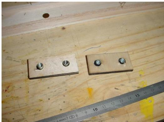
Coller ensemble deux pièces F1 et deux pièces F2 ensemble. Installer des écrous à griffes M4
