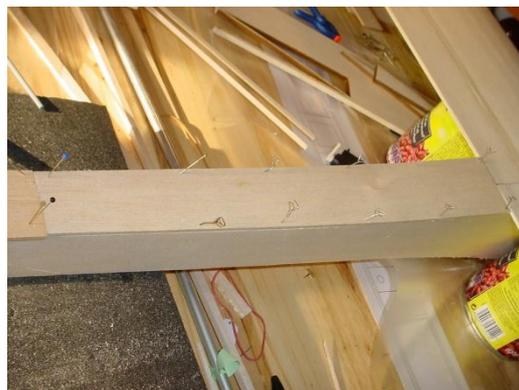
Coller le coffrage au dessus et au dessous (balsa 2 mm fibre perpendiculaire à l'axe longitudinal, pas comme sur la photo
