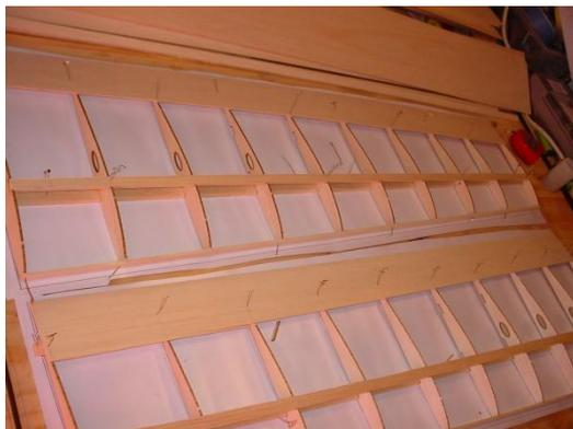
Coller le coffrage de bord de fuite (profondeur 50 mm)
