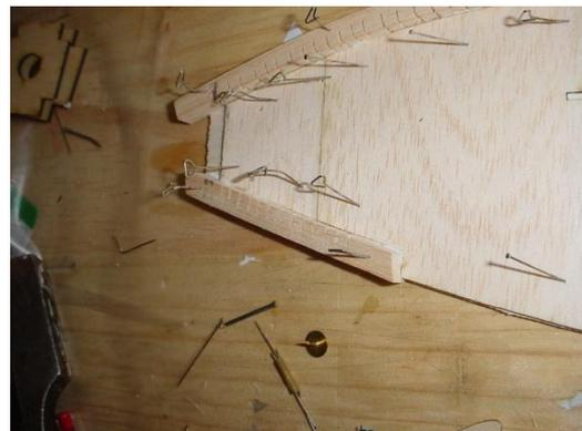
Coller la baguette située au niveau du nez (balsa 8x8). A noter les coups de scie dans les baguettes pour faciliter leur cintrage.
