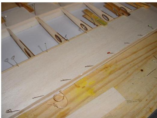
Coller le coffrage entre le longeron et le bord d'attaque (balsa 1,5 mm)
