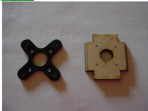
Coller F5 sur F6, repérer et percer les points de fixation du moteur.
