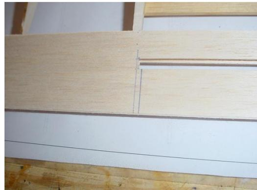
Découper latéralement suivant une largeur de 4 mm (distance entre les traits tracés sur la structure)
