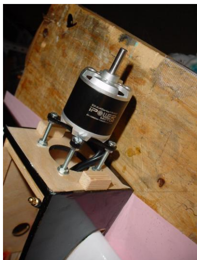
Installation des moteurs sur les nacelles
