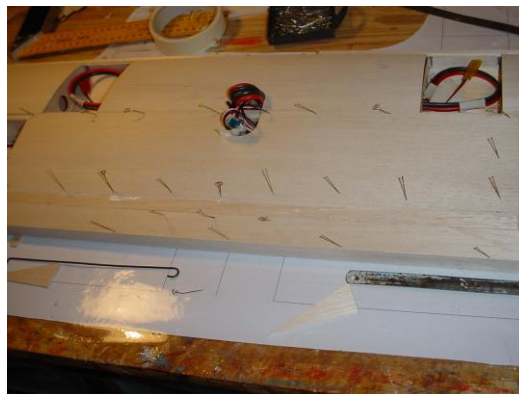
Terminer la pose du coffrage de la partie centrale
