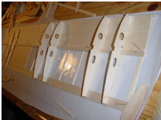
Coller les nervures suivant l'image
