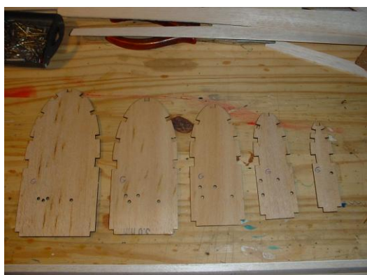
Repérer le sens Gauche/droite sur les couples situés dans la partie arrière du fuselage
