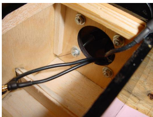
Vue sur les écrous et les rondelles situés derrière le couple moteur
