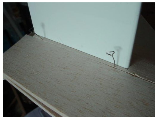
Ajouter une bande de 5 mm de haut juste sous le stabilisateur
