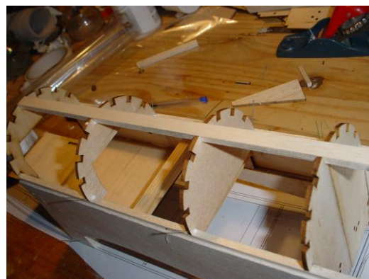
Positionner et coller la baguette balsa 10x5
