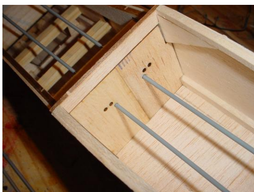
Placer les gaines de commande de dérive
