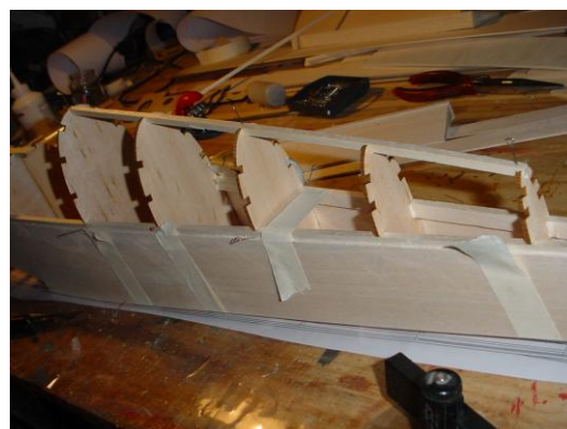
Coller la baguette balsa reliant tout les couples
