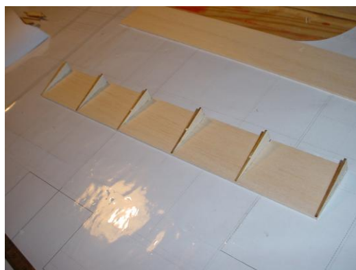
Coller les queues de nervure sur le coffrage d'intrados
