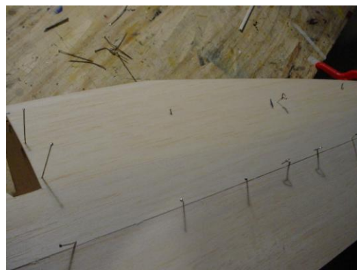
Encoller et épingler le coffrage sur la structure du fuselage
