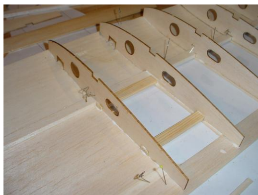
Coller les nervures situées au niveau des nacelles moteur
