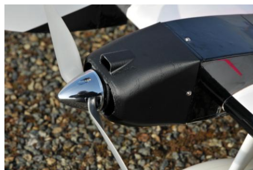
Impression 3D des capots et mise en place sur la cellule
