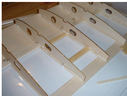
Coller les nervures au niveau du servo d'aileron
