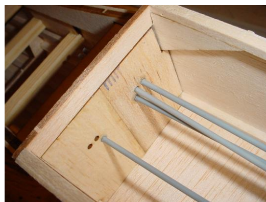
Placer les gaines de commande de profondeur
