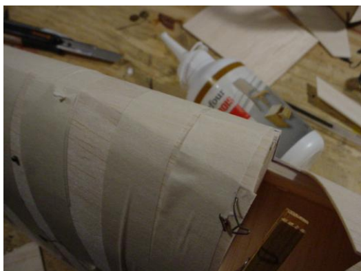
Compléter le coffrage par une chute taillé en triangle
